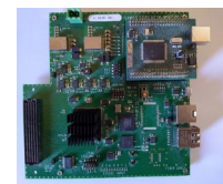
Figure 4 Haut : l'hodoscope faisceau avec le jeu des 2 cartes filles diamant + la carte mère avec 40 voies d'électronique + principe de la détection par pistes en X et Y. Bas : carte d'acquisition avec 40 TDC sur FPGA
