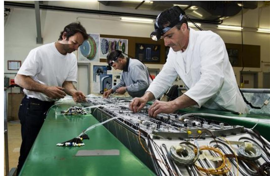
Mise en place des fibres pour le suivi par laser
