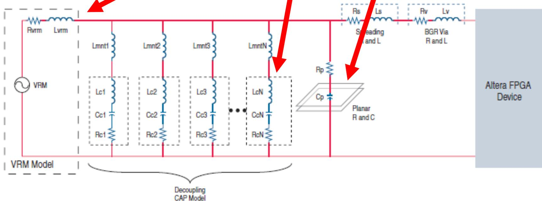
Par exemple, sur la carte Nepal, le condensateur constitué des plans d'alimentation GND et VCC=0,9V a une capacité de 4,1 nF .
