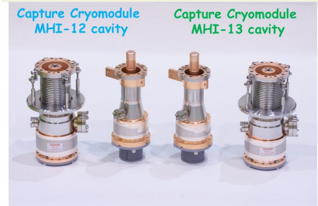
STF-2' (A) input coupler SUS 0.8t + Cu 5 μm Capture Cryo. - MHI-12
