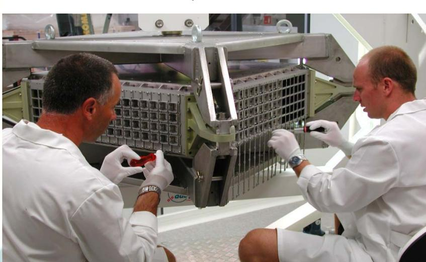
Calorimètre Plomb-Scintillateur. Poids:  $\leq 630$  kg
