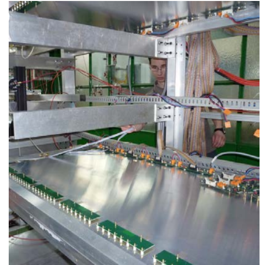
Cartes FE prototypes équipées de l'ASIC des RPCs de CMS sur banc de test RPC (Turin)
