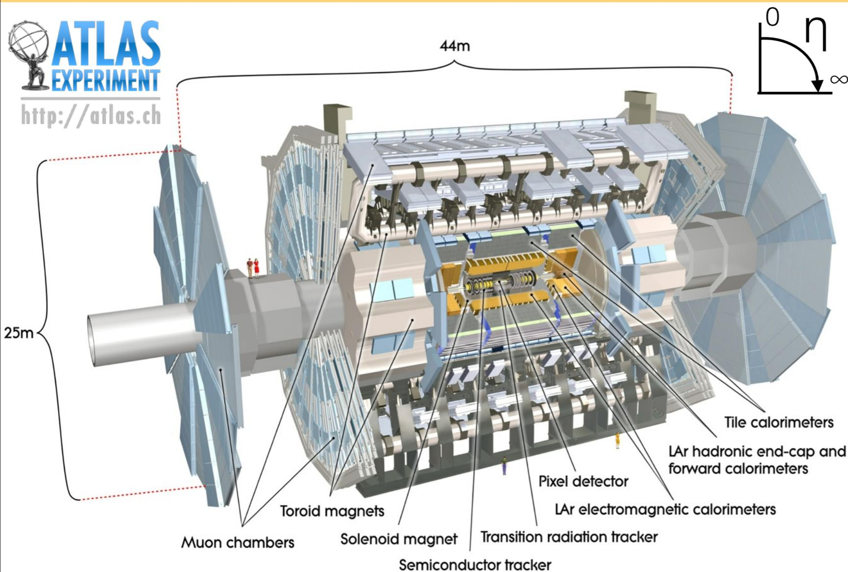
**Muon Spectrometer:**  $|\eta| < 2.7$
