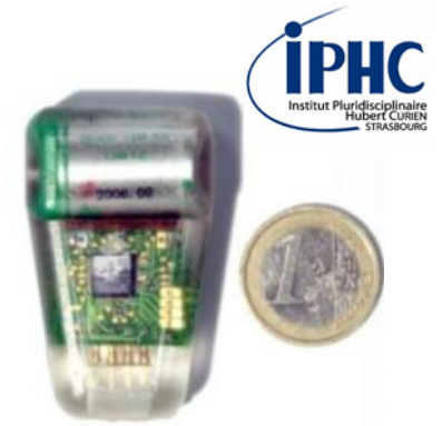
Imprégnation par résine de systèmes d'acquisition embarqués sur animaux
