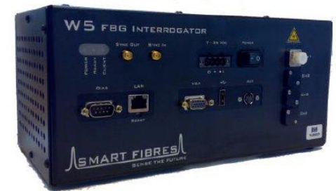
Exemple de système d'interrogation ( <125 capteurs / voie ; <16 voies )
