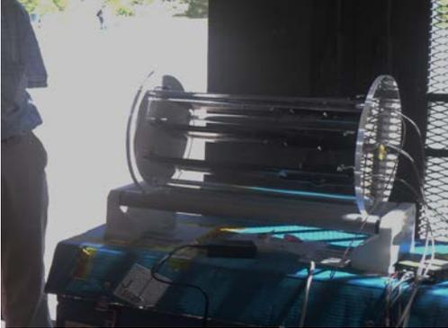
Une roue cosmique est un ensemble de capteurs (scintillateurs et photo-multiplicateurs) permettant de compter le nombre de rayons cosmiques qui les traversent. On utilise un système en coïncidences pour éliminer tout ce qui ne serait pas des rayons cosmiques. Il s'agit de compter les rayons qui traversent simultanément plusieurs plaques de scintillateurs.
