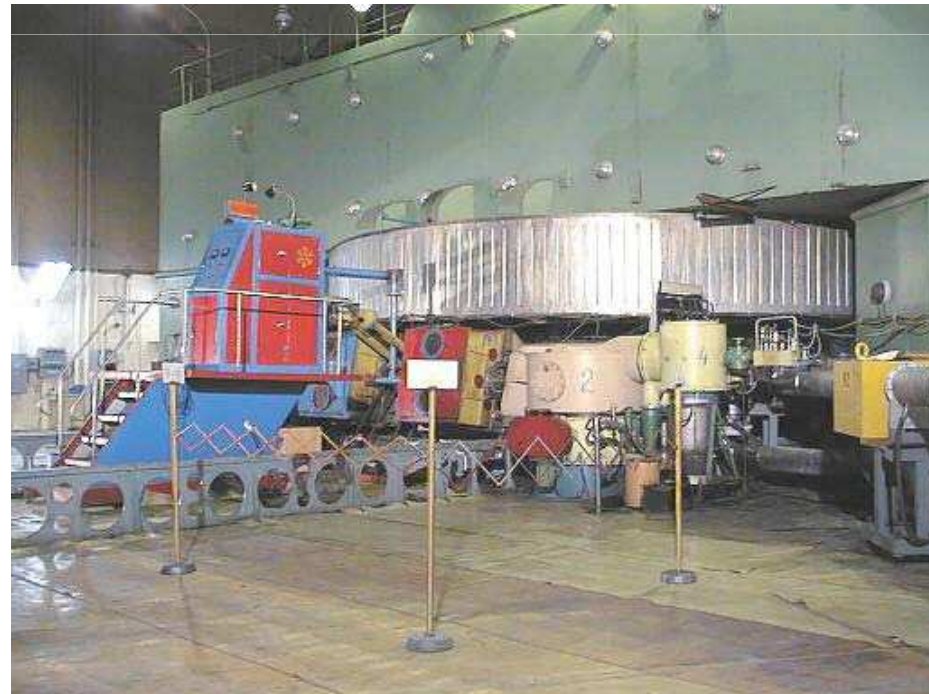
Gatchina StPetersburg (1 GeV protons, 1967) 8 000 t, 7 m diamètre
