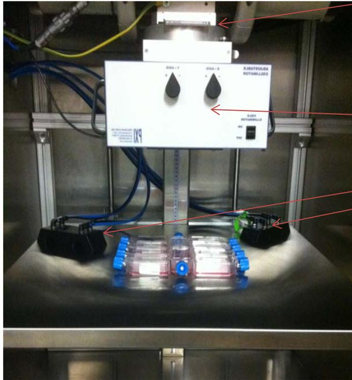
Filtre 2 mm Al pour les cellules ou 1,5 mm Al + 0.25 mm Cu + 0.75 mm Sn pour les animaux
