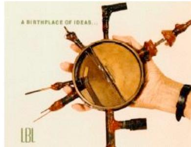
1er cyclotron en 1931,  $V=1.8\text{KV}$ ,  $d\sim 12\text{ cm}$
