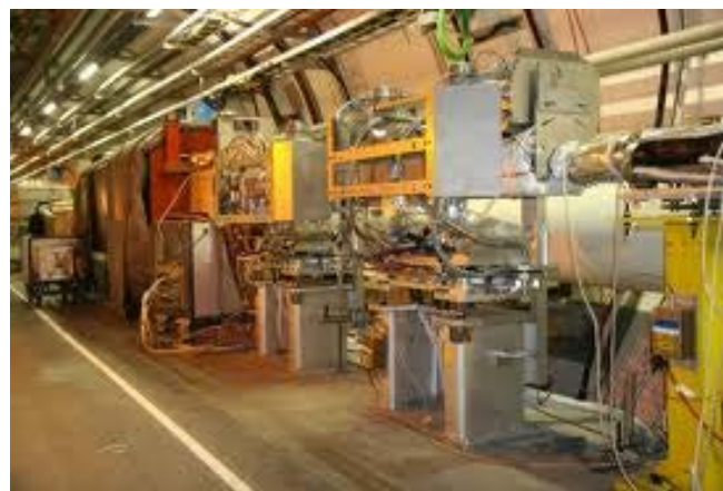
Collimateurs : 99.9% des pertes
