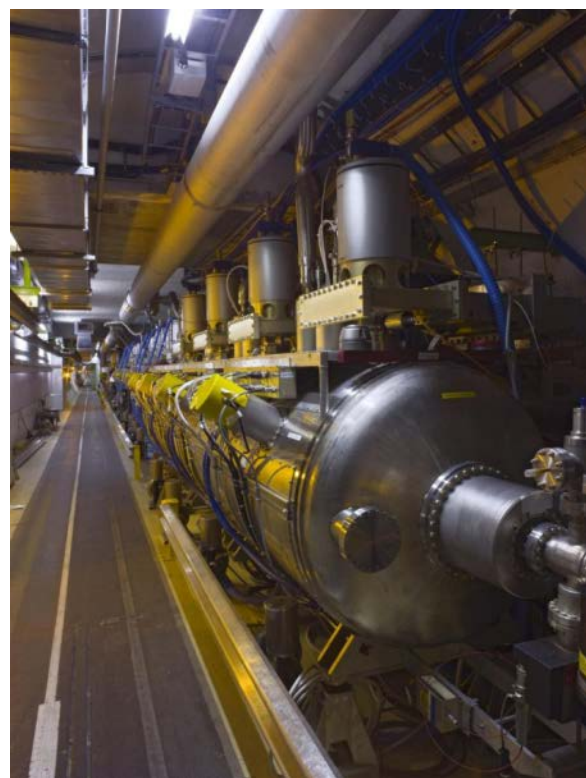
Cavités 400 MHz SCRF (2x 15 m)
