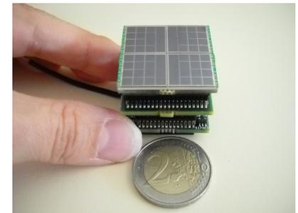
XEMIS1 en test : hautes résolutions énergétique ( $\sim 6\%$ ) et spatiale ( $\sim 0.5\text{mm}$ )
