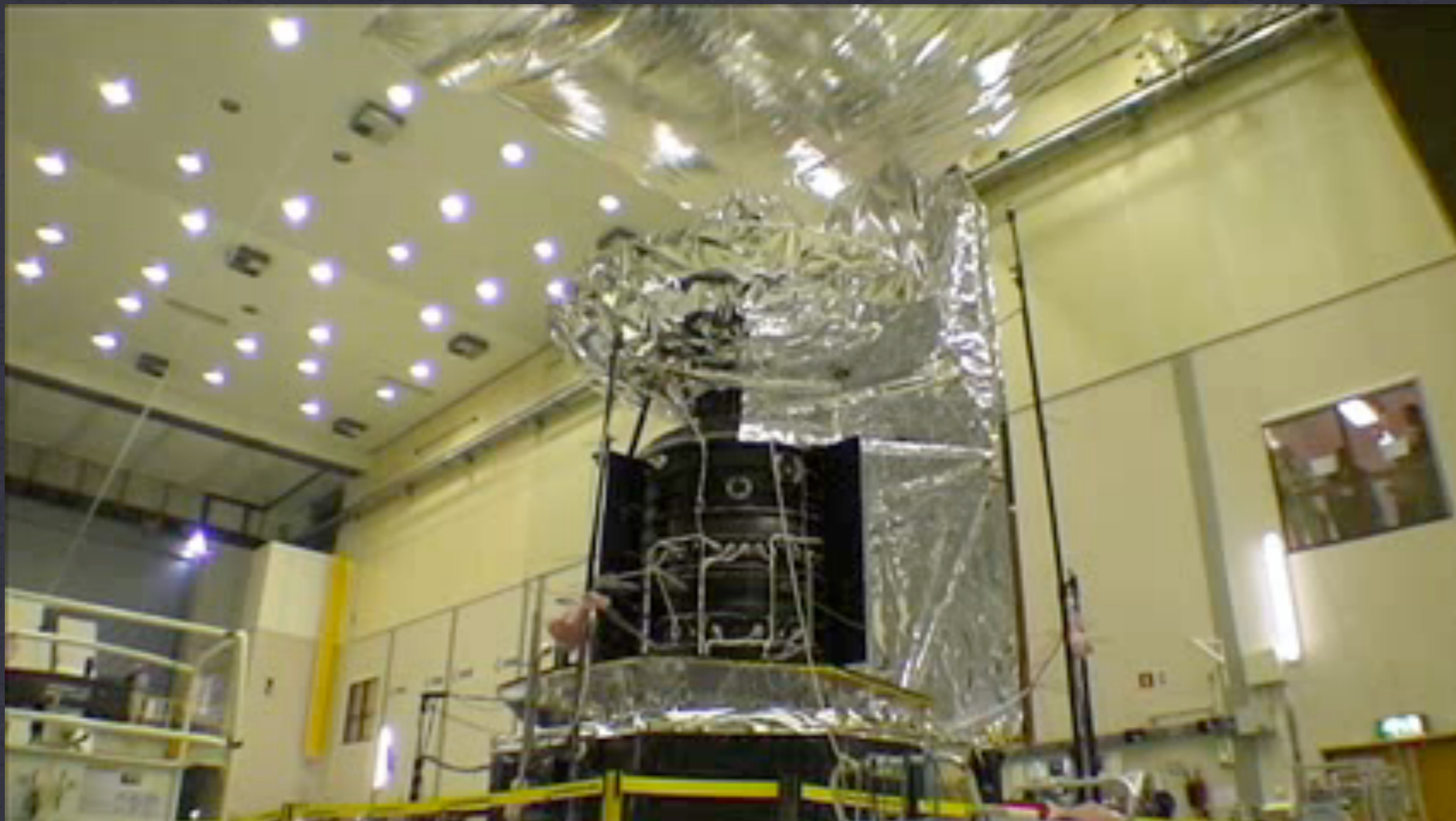
Test de vibration du satellite Herschel complet
