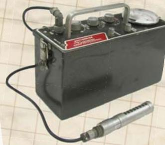
En 1928 le compteur Geiger-Müller est mis au point. C'est une chambre cylindrique remplie d'un gaz sous faible pression et traversée par un fil métallique porté à une tension de l'ordre de 1000 volts. Au passage d'une particule chargée, le gaz est ionisé et les électrons arrachés se multiplient, rendant le gaz conducteur et provoquant un phénomène de décharge, qui produit une impulsion électrique sur le fil. Ce compteur permet de détecter une à une les particules le traversant.
