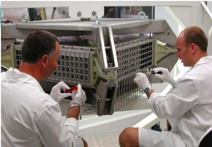
Calorimètre Plomb-Scintillateur. Poids:  $\leq 630$  kg
