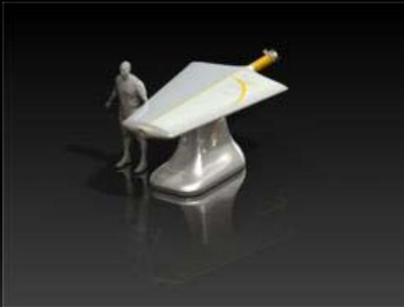
Prototype d'accélérateur proton, basé sur la technique DWA, construit par Compact Particle Acceleration Corporation pour le Southwest Oncology Centers (Yuma Arizona)
