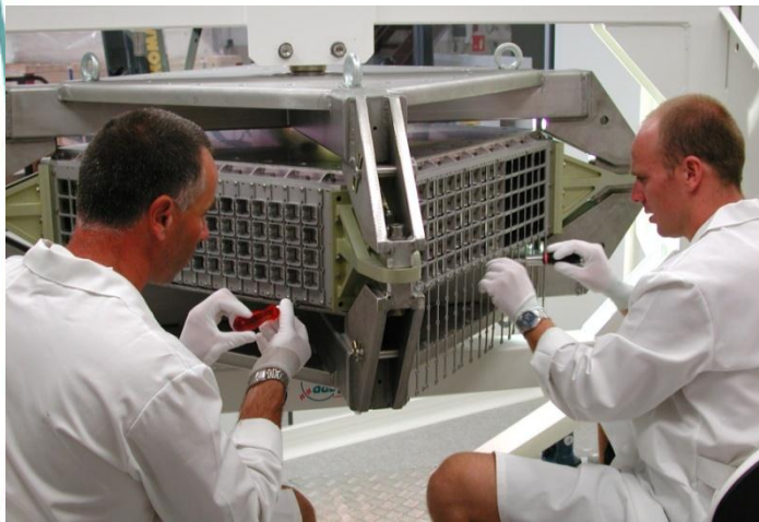
Calorimètre Plomb-Scintillateur. Poids: \leq 630 kg
