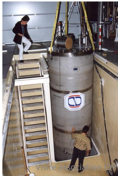
Mise à froid dans le cryostat rempli d'argon liquide
