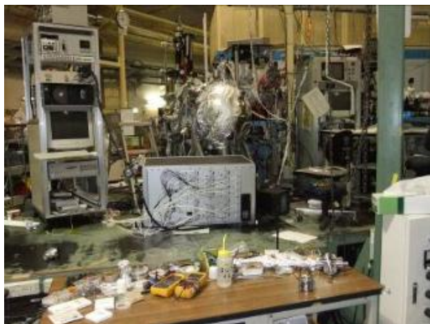
実験用電源の転倒
