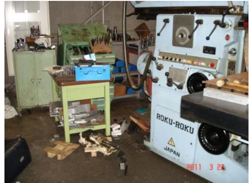
工具棚の転倒、ジグの落下、工作機械の横ズレあり。
