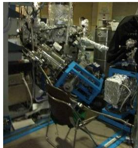
仮設真空槽の転倒
