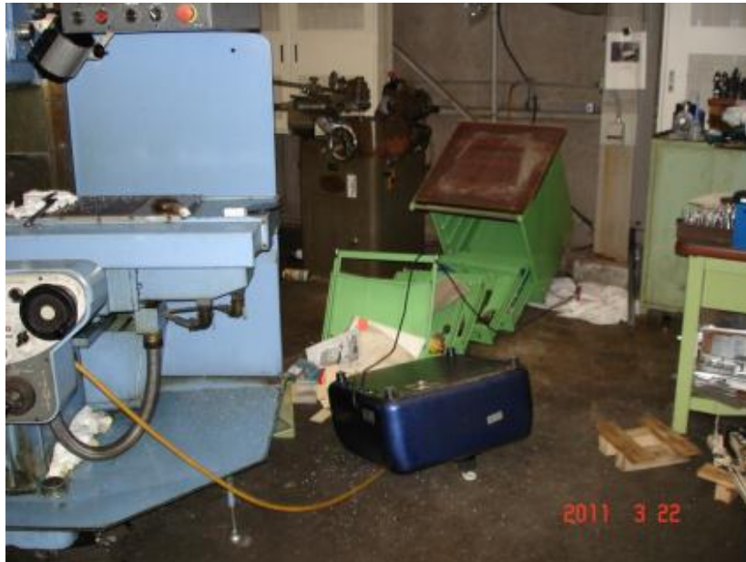
工作機器用棚の倒壊、上に載っていた装置も落下転倒した。
