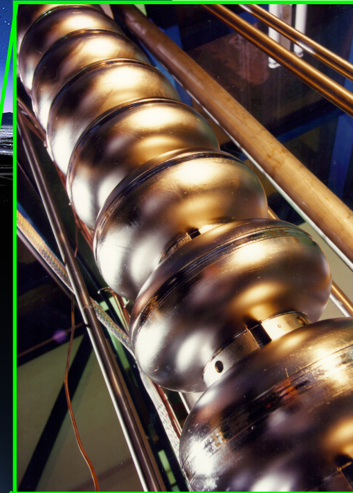
« résonateurs » (cavités métalliques, parfois supracond.)
