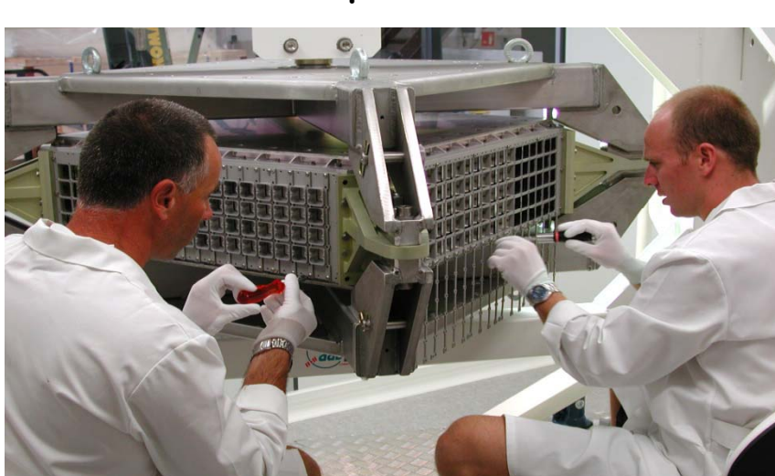
Calorimètre Plomb-Scintillateur. Poids: \leq 630 kg
