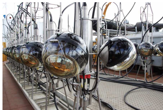
Modules optiques d'une des douze lignes de détection du premier télescope sous-marin à neutrinos, ANTARES, immergé par 2500 mètres de fond au large de La Seyne/Mer © Cea/L. Fabre
