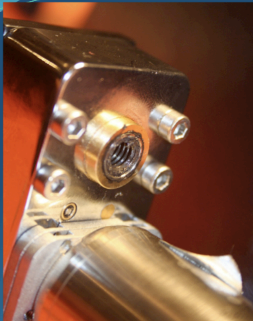
Copeaux de l'engrenage en laiton du réducteur dans l'écrou de la vis mère
