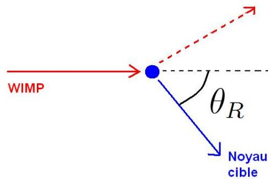
**Collision élastique d'un WIMP sur un noyau cible du détecteur:**
