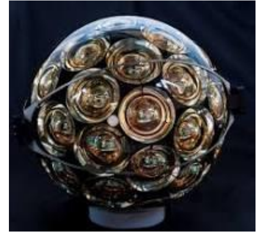
Construction de détecteur (DOM)
