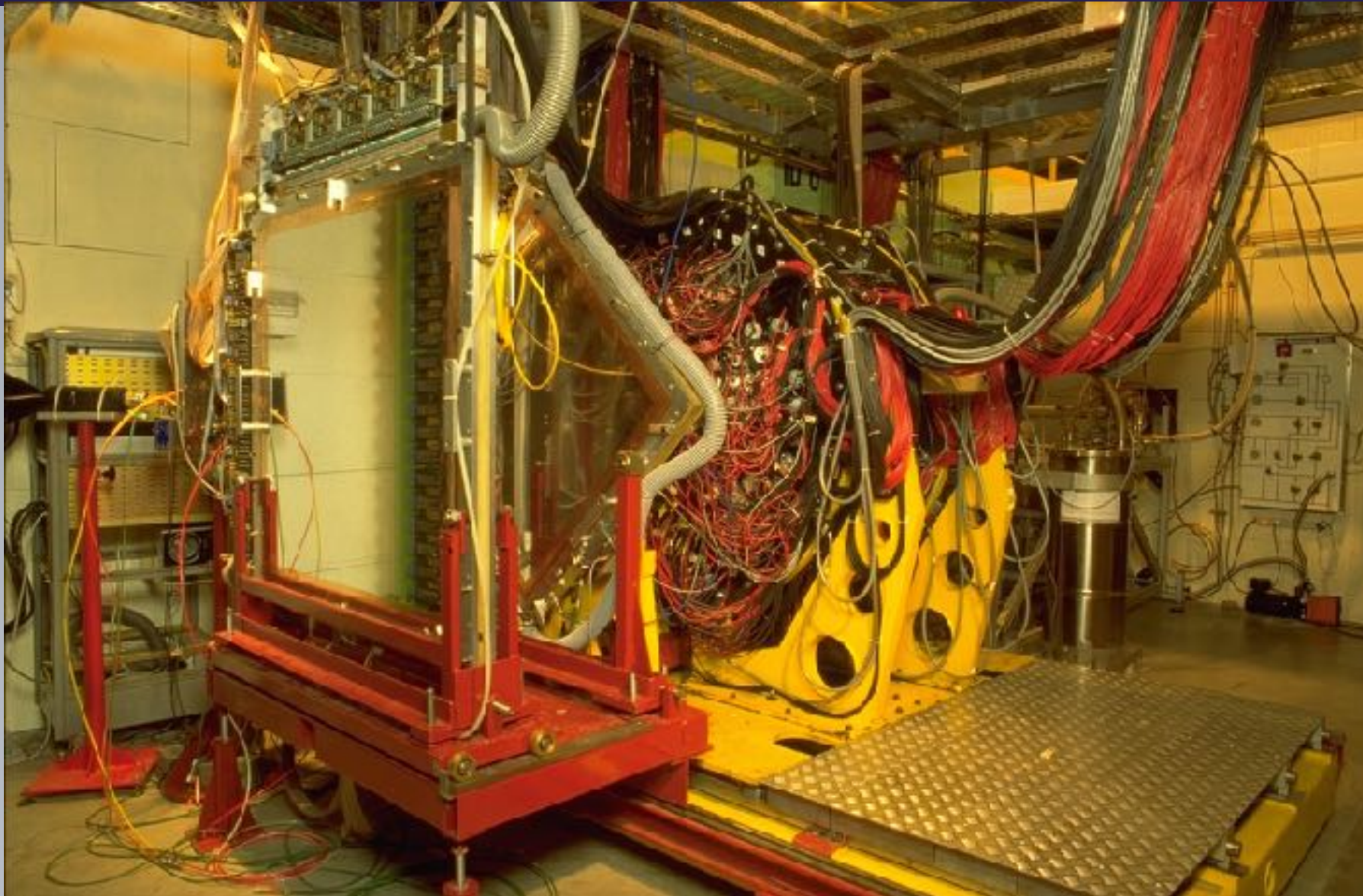
Exemple de Chambre à fils
