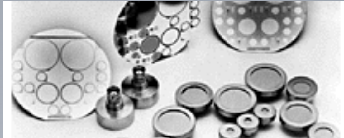
Exemple de matrices Silicium et détecteurs Silicium
