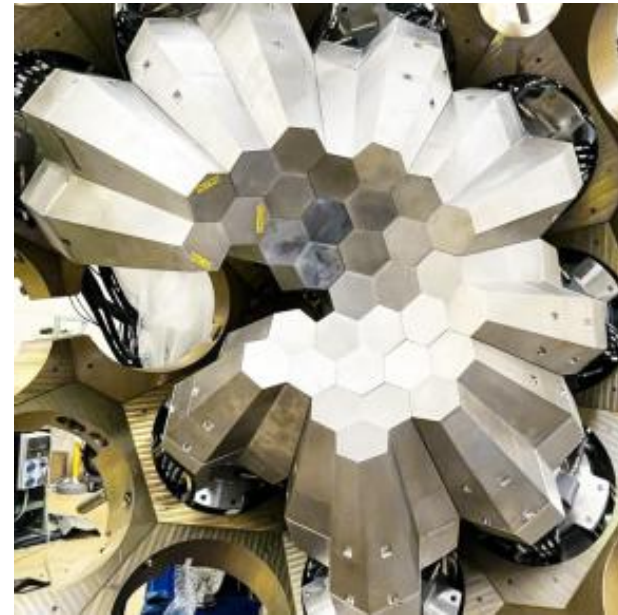
Agata : détecteur de gamma Diamètre 460 mm
