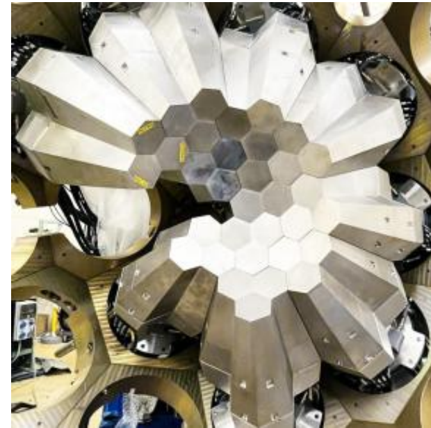
Agata : détecteur de gamma Diamètre 460 mm
