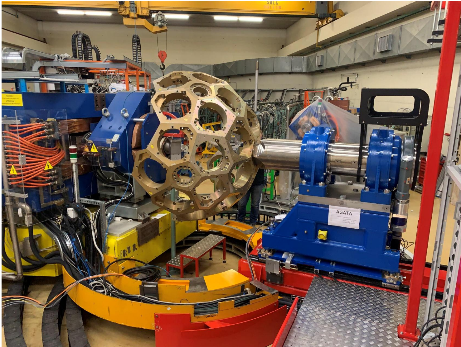
Agata : détecteur de gamma Diamètre 460 mm
