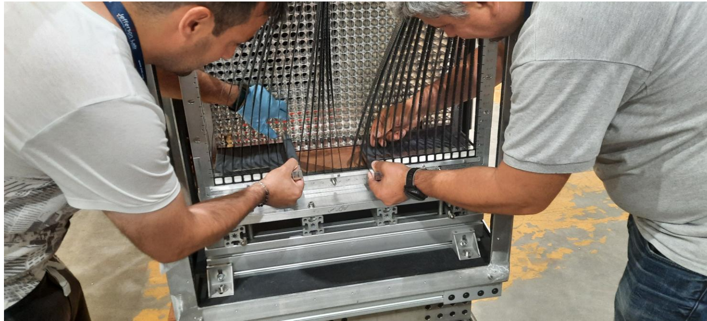
Mise en place des cristaux un par un
