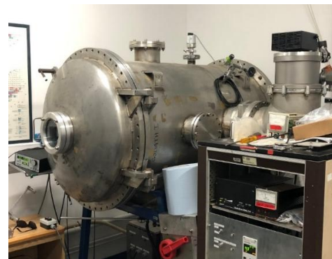
Evaporation sous vide / Canon à électrons
