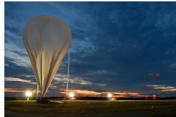
Remplissage He du ballon avant le décollage
