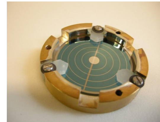
Montage fin bolomètre
