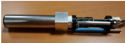
Assemblage des 1080 blocs PMTs
