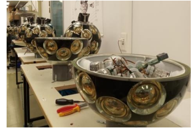
Intégration des modules optiques
