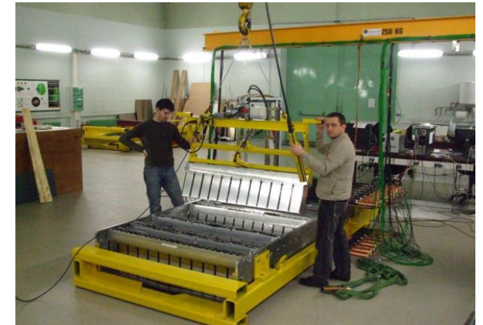
Assemblage des Stripmodules en Supermodule
