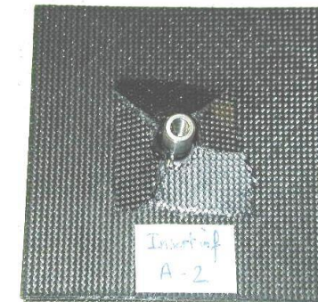
Eprouvette de test après rupture
