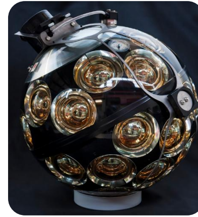
Intégration des modules optiques
