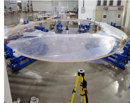
Pré-assemblage de l'acrylique
