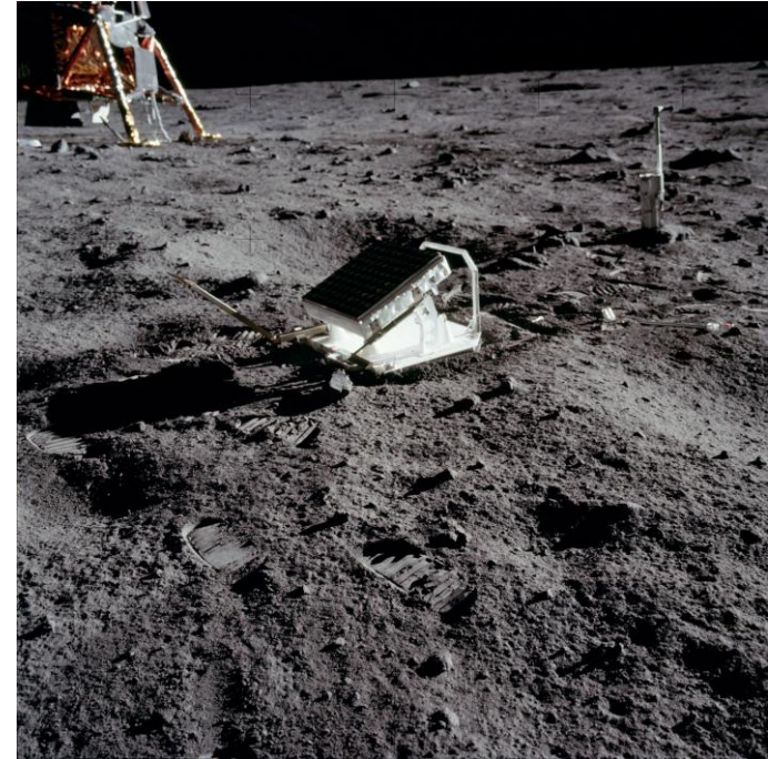
Réflecteur sur la surface de la Lune Distance à la terre : \sim 384\,400\text{ km}
