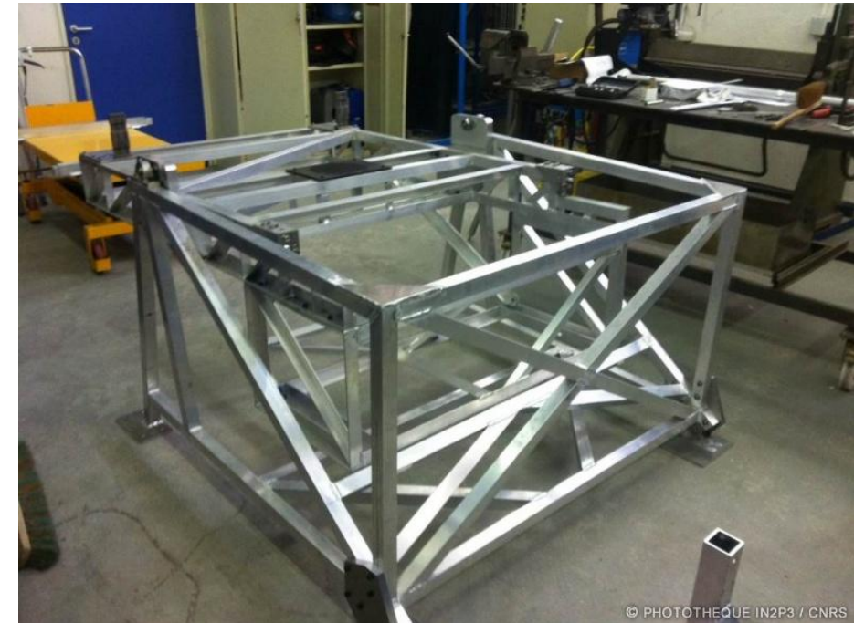
Châssis en aluminium soudé pour le chargeur de filtre de LSST(LPSC)
