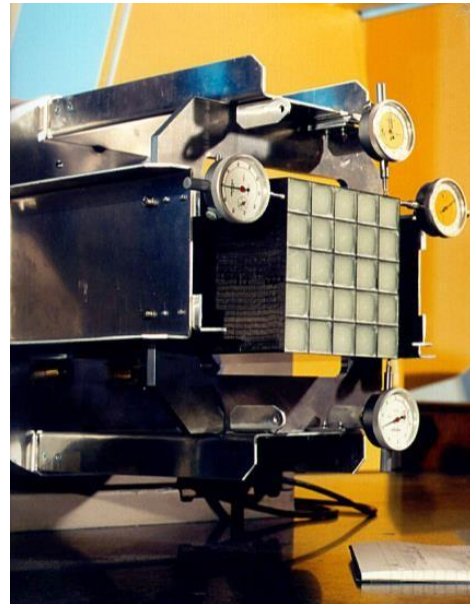
Mesure de la géométrie (longueur) des cristaux CMS
