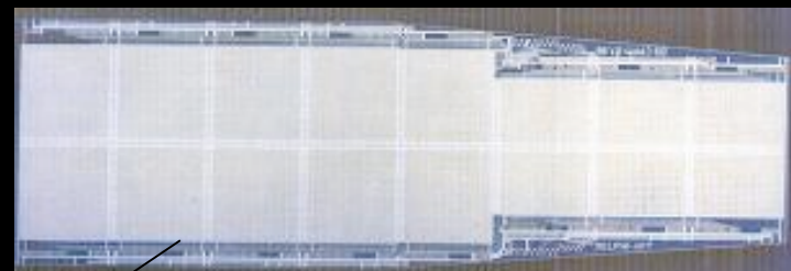
Capteur de silicium pixellisé 330 \times 330 \mu\text{m}^2 (DELPHI)
