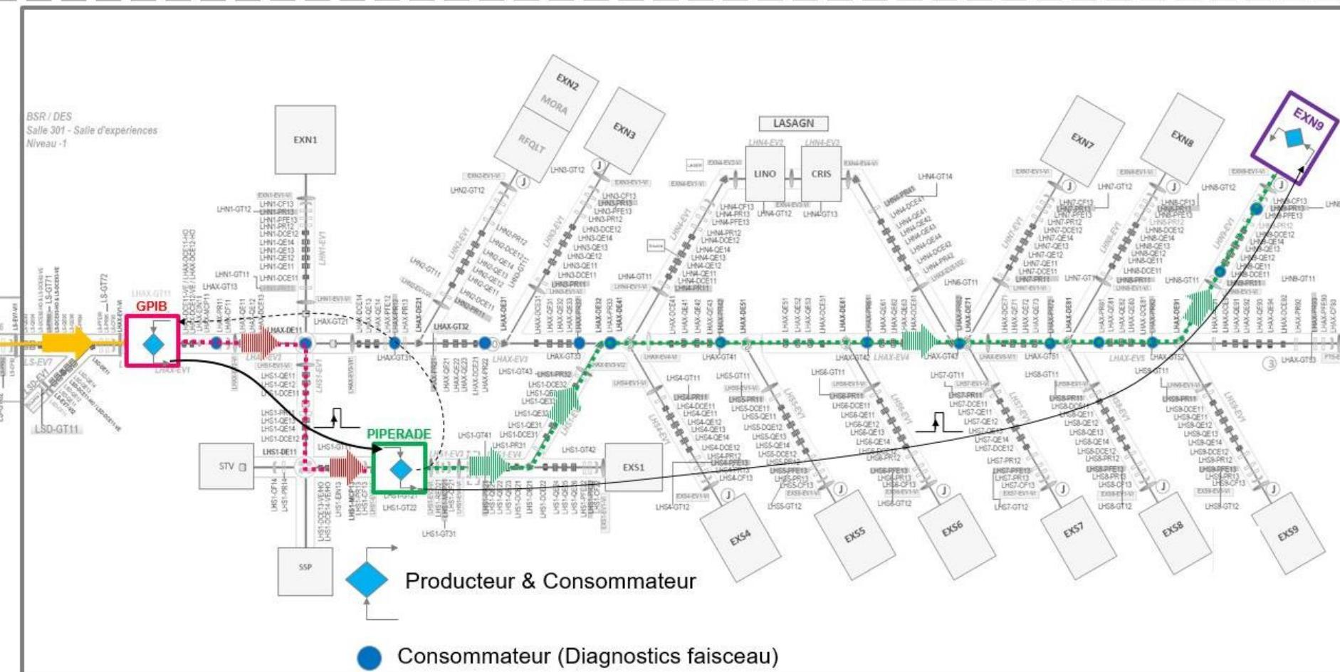
**Faisceau SPIRAL1 continu** (sans besoin de synchro GPIB sur Hacheur SP1)
