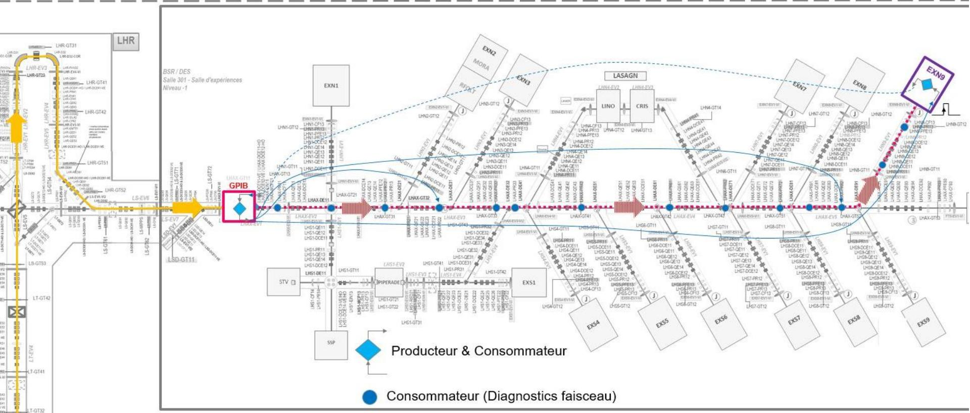
Faisceau SPIRAL1 continu (sans besoin de synchro GPIB sur Hacheur SP1)
