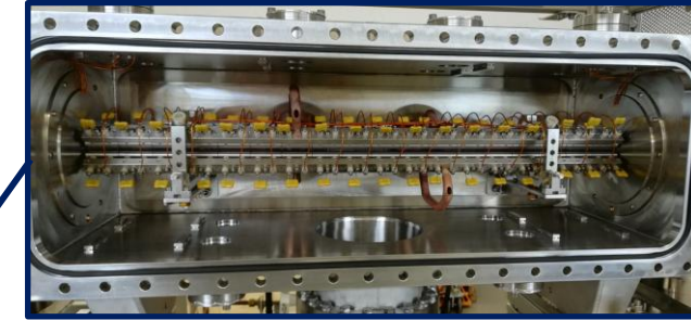
Accès au quadripôle après retrait de la trappe de visite
