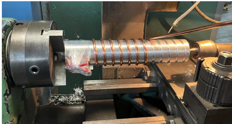
Mise en forme du tube en cuivre
