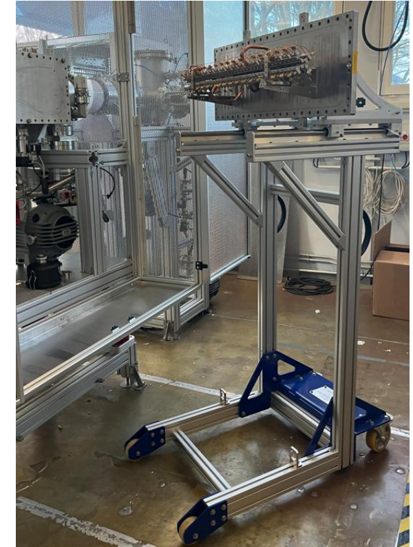
Le quadripôle et sa bride sur leur charriot de manutention
