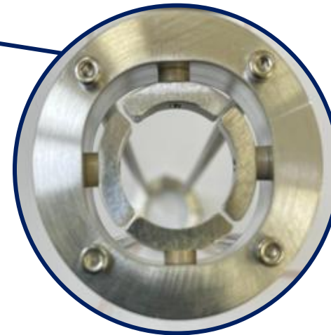
Les 4 électrodes permettant d'évaluer la position du faisceau
