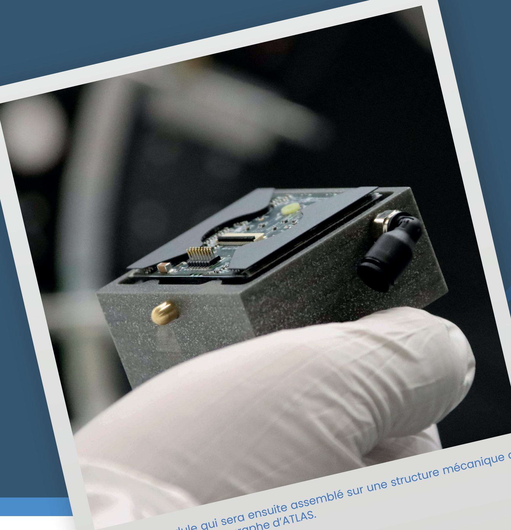
Vue sur le module qui sera ensuite assemblé sur une structure mécanique qui
