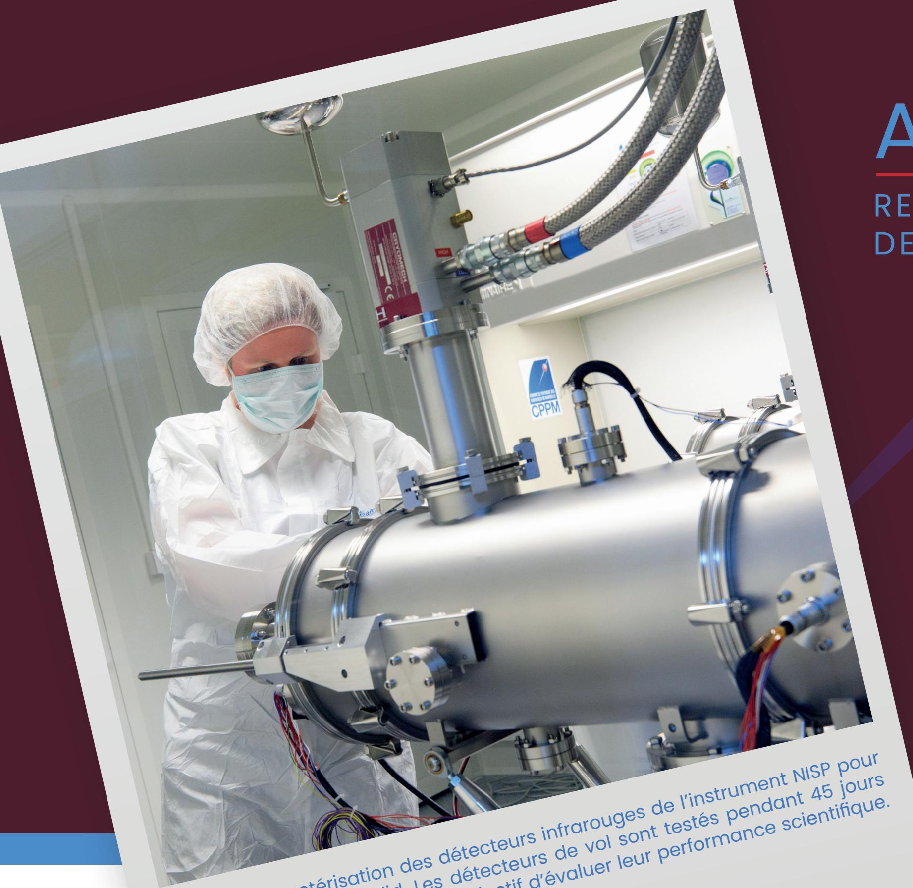
Bancs de caractérisation des détecteurs infrarouges de l'instrument NISP pour la mission spatiale Euclid. Les détecteurs de vol sont testés pendant 45 jours sous vide, à -200°C avec pour objectif d'évaluer leur performance scientifique.
