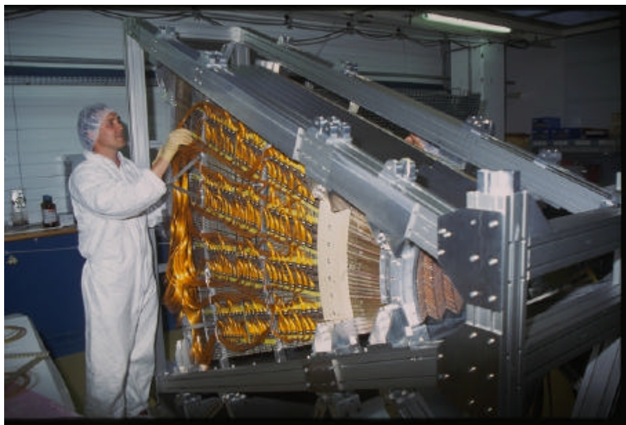
Un module du calorimètre électromagnétique d'Atlas en salle propre au CPPM, © CPPM
