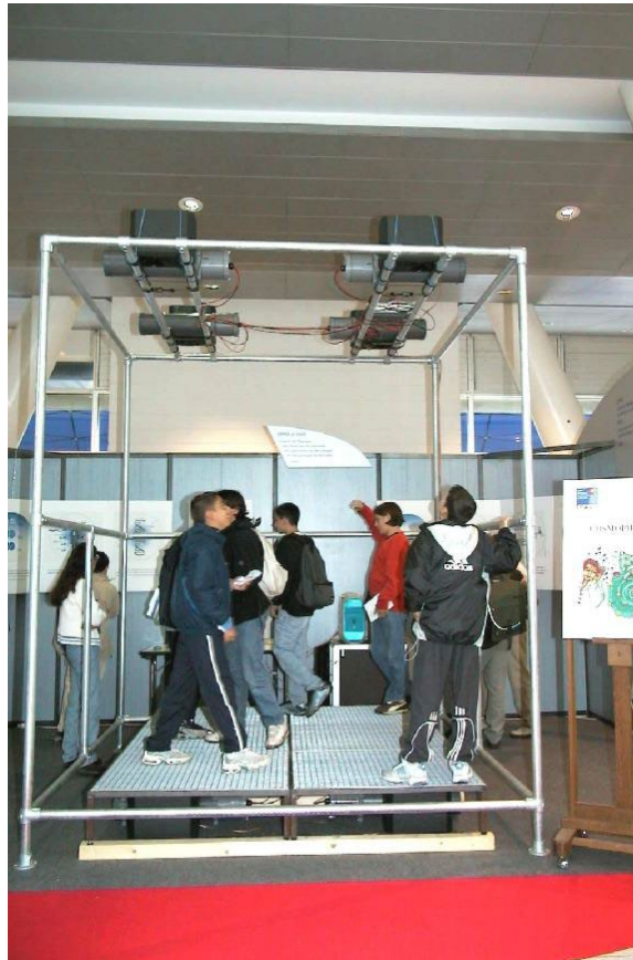
Le Cosmophone, installation sonore qui détecte et restitue en temps réel, le flux des rayons cosmiques ambiants. Un dispositif similaire est installé de manière permanente à la Cité des Sciences et de l'Industrie de La Villette-Paris. ©CPPM
