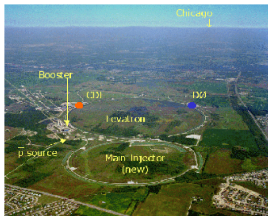
Le Tevatron accélère des protons contre des antiprotons à 900 GeV.
