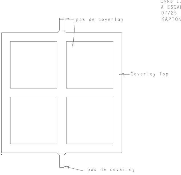
LE COVERLAY DOIT RECOUVIR LES PASTILLES ET TROUS
