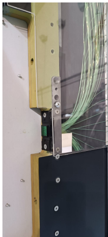
Connecteur 64 fibres en bord de module
