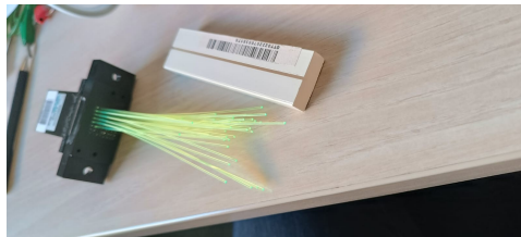
Échantillon de barreau scintillateur, connecteur fibres et photomultiplicateur (PM)
