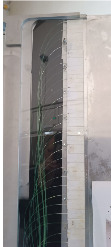
Fibres sortant des barreaux scintillateurs, en bord de module
