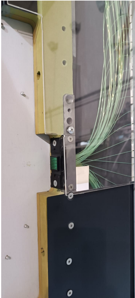
Connecteur 64 fibres en bord de module
