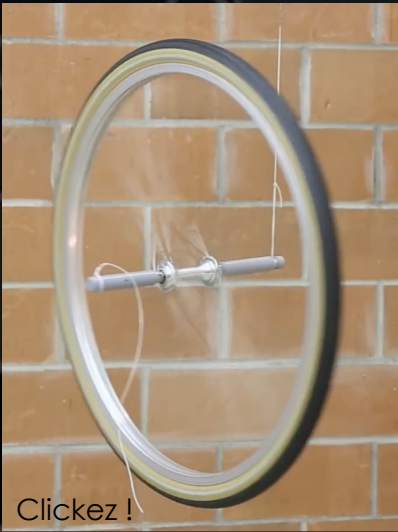
Effet gyroscopique => stabilité du vélo
