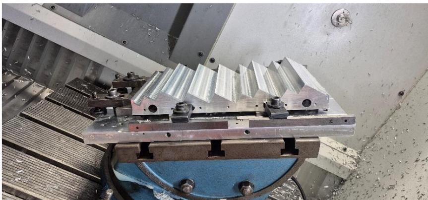
*Usinage des marche, contrôle métrologique < 0.05mm*
