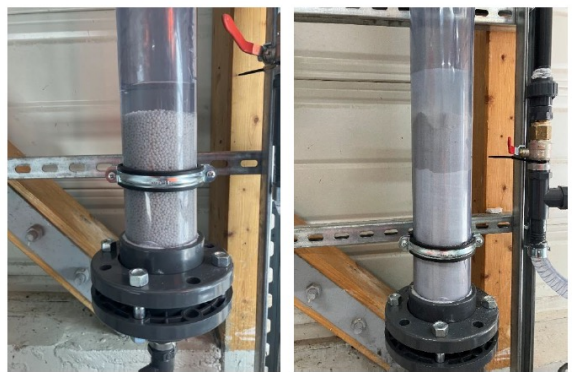
Figure 4 : Filtration sur billes Beadmet (à gauche), et sur résine SIMPUR (à droite)
