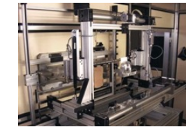
Porte échantillon pour irradiation
