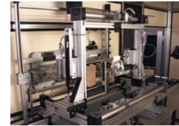
Porte échantillon pour irradiation
