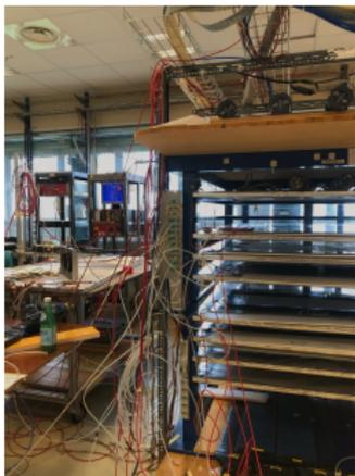
Figure 4: iRPCs en train d'être testées sur des stands cosmiques.
