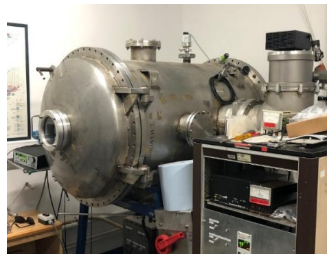
Evaporation sous vide / Canon à électrons
