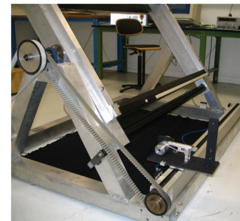
Outillage de tissage de fils sur les cadres de transfert
