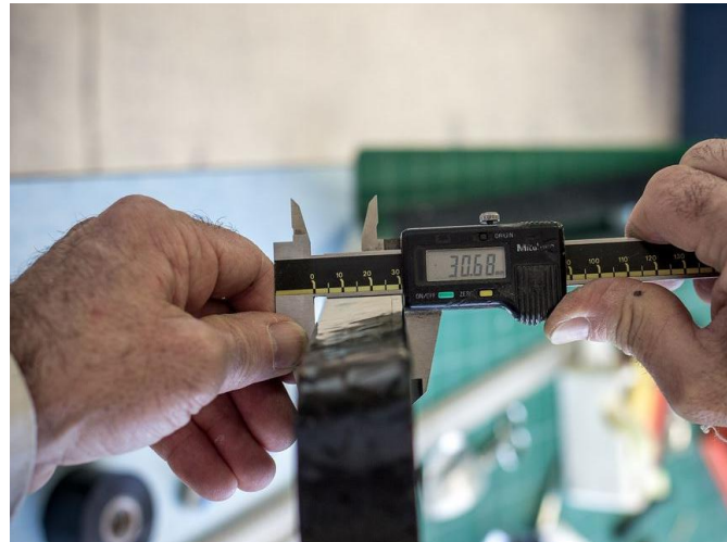
Vérification de l'épaisseur d'une latte
