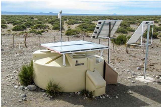
Scintillateurs de surface (SSD) au-dessus de la cuve à eau Tcherenkov pour l'Upgrade d'Auger
