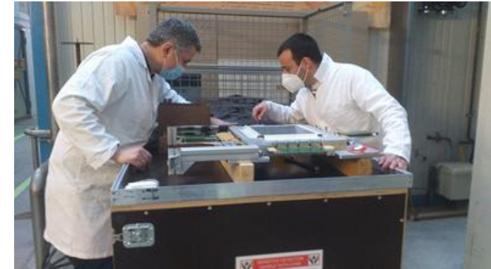
Réparation de fils cassés sur SOFIA. Envoi de la chambre de GSI (Allemagne) vers Orsay
