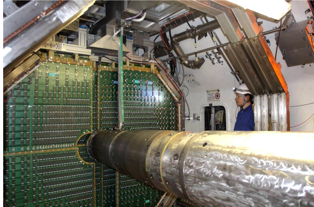
Installation des quadrants et du refroidissement
