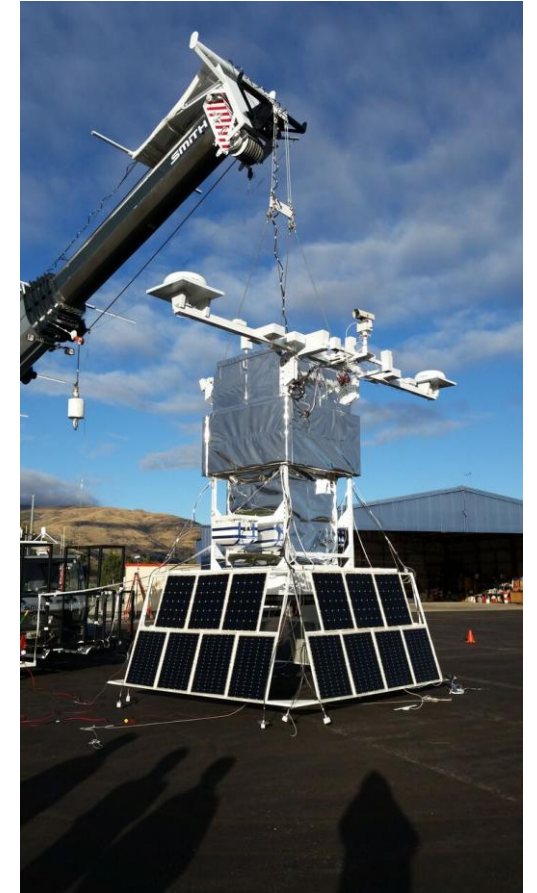
EUSO-SPB équipé de panneaux solaires (mission plus longue)
