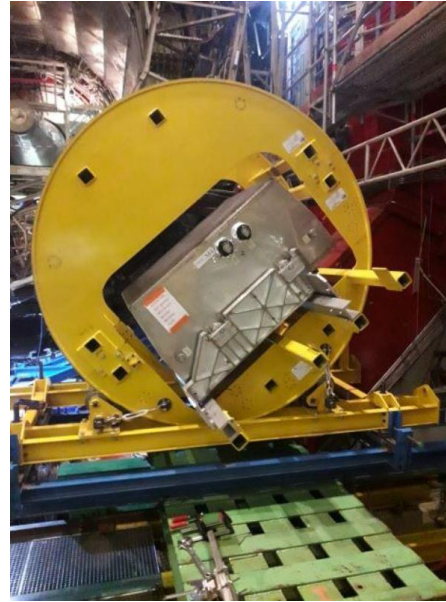
Positionnement de l'outil et insertion des supermodules
