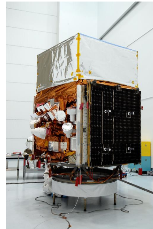
Télescope Fermi (2,5 m de côté et de 2,8 m de haut avec une masse de 4,3 tonnes)
