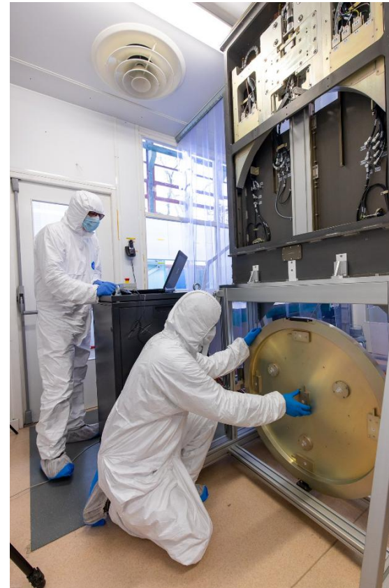
Intégration mécanique du chargeur de filtre
