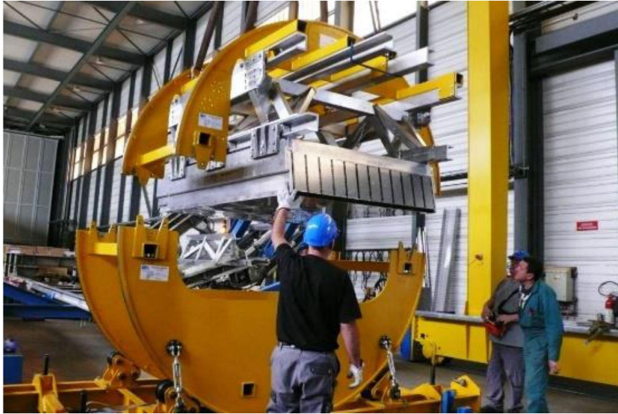
Mise en place des supermodules dans l'outillage
