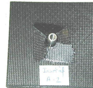
Éprouvette de test après rupture
