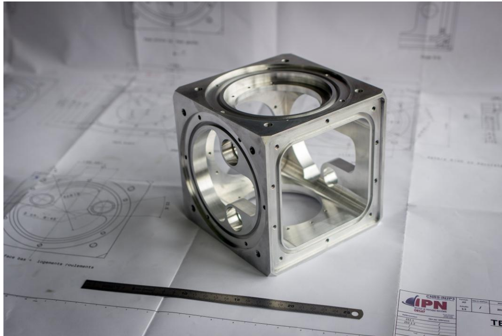
Usinage sur centre d'usinage 3 (+1) axes pour l'expérience BEDO (atelier d'Orsay)
